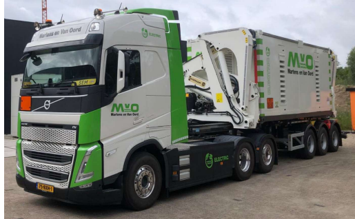
2 x Dens Powerhub 600 kVA 1.740 kWh met ingebouwde snelladers en 2 kleinere batterijen
