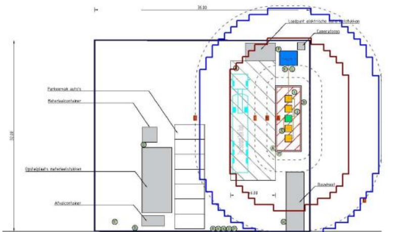
Figuur 2 Aandachtsgebieden (blauw = fakkelbrand, bruin = explosie) ten gevolge van vrijstaande gasflessenbatterijen (lijn van vierkanten) op de bouwplaats.
