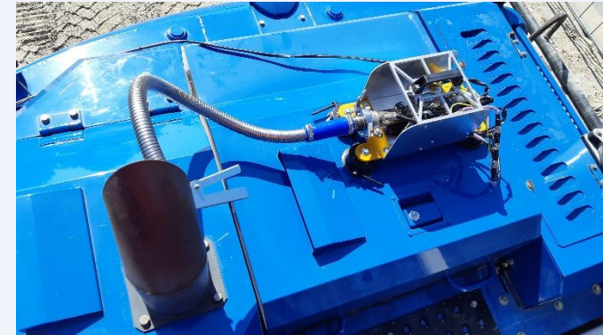
Draagbaar NOx-emissiemeetsysteem van TNO "BOEM-kit"
